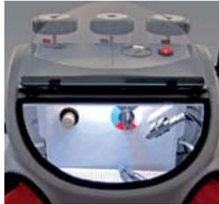
Iluminación con led orientable y película de protección intercambiable
