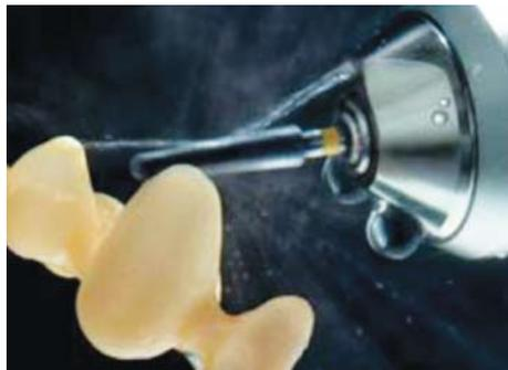
Figura 15.- Se debe reparar con refrigeración de agua.
