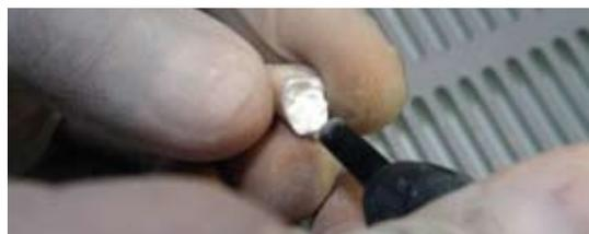
Foto 31. Arenado para la eliminación fina del investimento.
