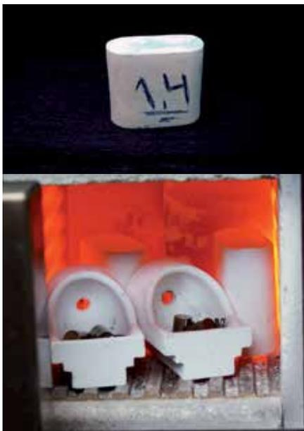
Fundimos de la manera convencional, siempre tratando de no quemar el metal, una manera de quemar menos el metal, es calentando el crisol junto con el metal, así se funde más rápido con la ayuda del soplete.
