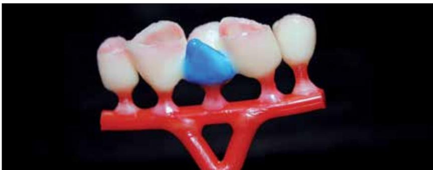
Usaremos la técnica que se basa en la densidad del metal, pesamos la cera y el resultado lo multiplicamos por la densidad del metal, con esta técnica evitamos quemar y desperdiciar el metal.
